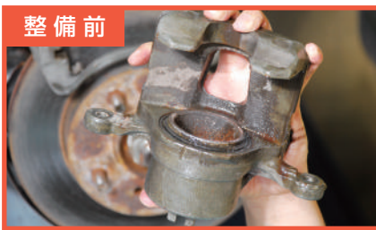
ブレーキ・キャリパのゴム部品が劣化し、液漏れしている状態
