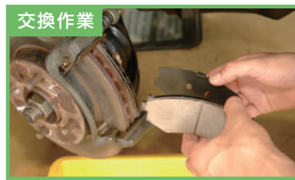
ブレーキ・パッドを車両から取り外し中
