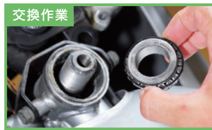
交換作業 ステアリングステムベアリングを分解し、ベアリングを交換中
