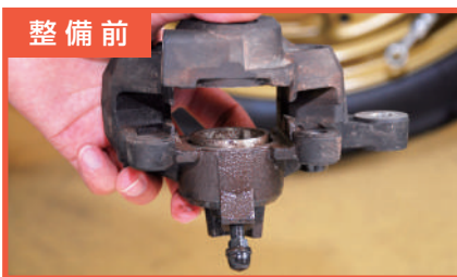
整備前 ブレーキ・キャリパのゴム部品が劣化し、液漏れしている状態
