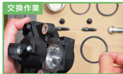
交換作業 ブレーキ・キャリパを分解清掃し、内部の部品を交換中
