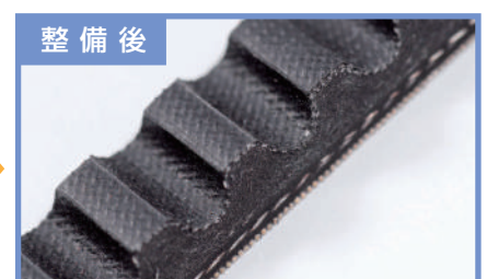
整備後 ドライブ・ベルトが新品の状態
