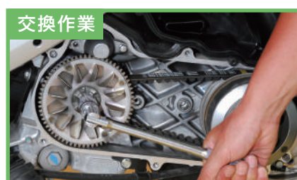
交換作業 ドライブ・ベルトを交換中
