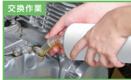
交換作業 新品のエンジン・オイルをエンジンに注入中
