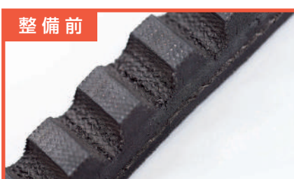
整備前 ドライブ・ベルトにひび割れがある状態
