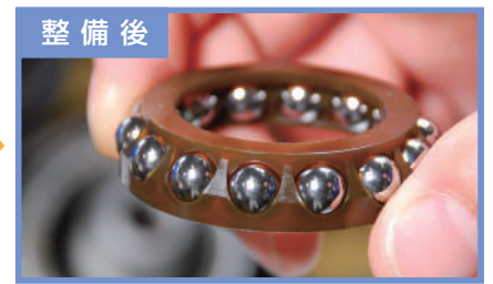
整備後 ステアリングステムベアリングが新品の状態（写真は車両への取付前の状態）
