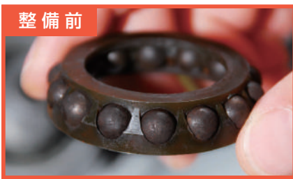
整備前 ステアリングステムベアリングに錆が派生している状態（写真は車両から取外した状態）
