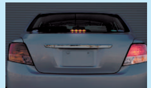
電球が切れたため点灯しないブレーキランプ
