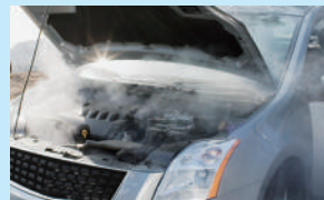
冷却不良によるオーバーヒート
