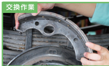
交換作業 ブレーキ・シューを車両から取り外し中
