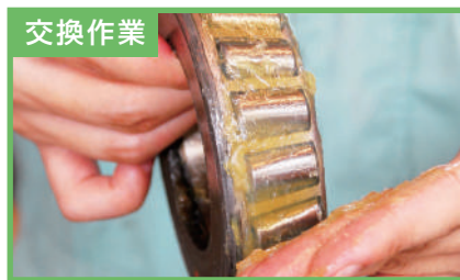
交換作業 ハブ・ベアリング・グリースを清掃し、新しいグリースを充填中
