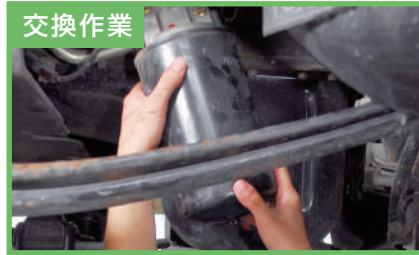
交換作業 エンジン・オイル・フィルタをエンジンから取り出し中
