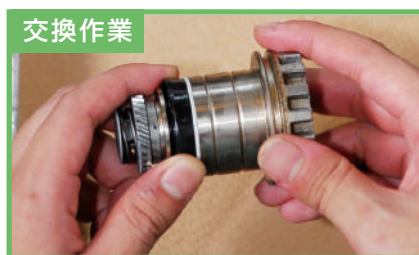
交換作業 ホイール・シリンダ内部を分解清掃し、内部の部品を交換流
