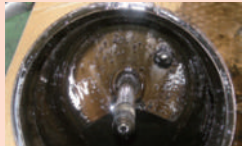
フィルタを突き抜けて異物とオイルが溜まったオイル・フィルタ・ケース
