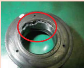
バルブの損傷
