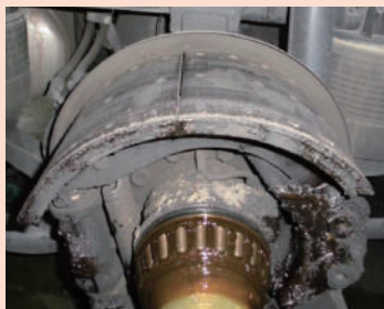
ブレーキ・ライニングの焼け 熱によるハブ・グリースの流出
