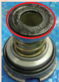
ゴム部品の膨張・変形
