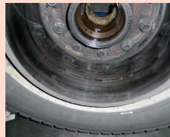
ブレーキ・ドラムの摩耗及び焼け
